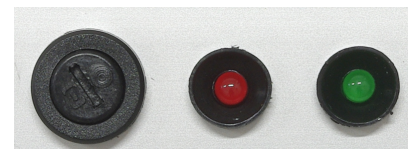
bezpiecznik w torze akumulatora awaria oprawy sieć/sygnalizacja ładowania akumulatora
