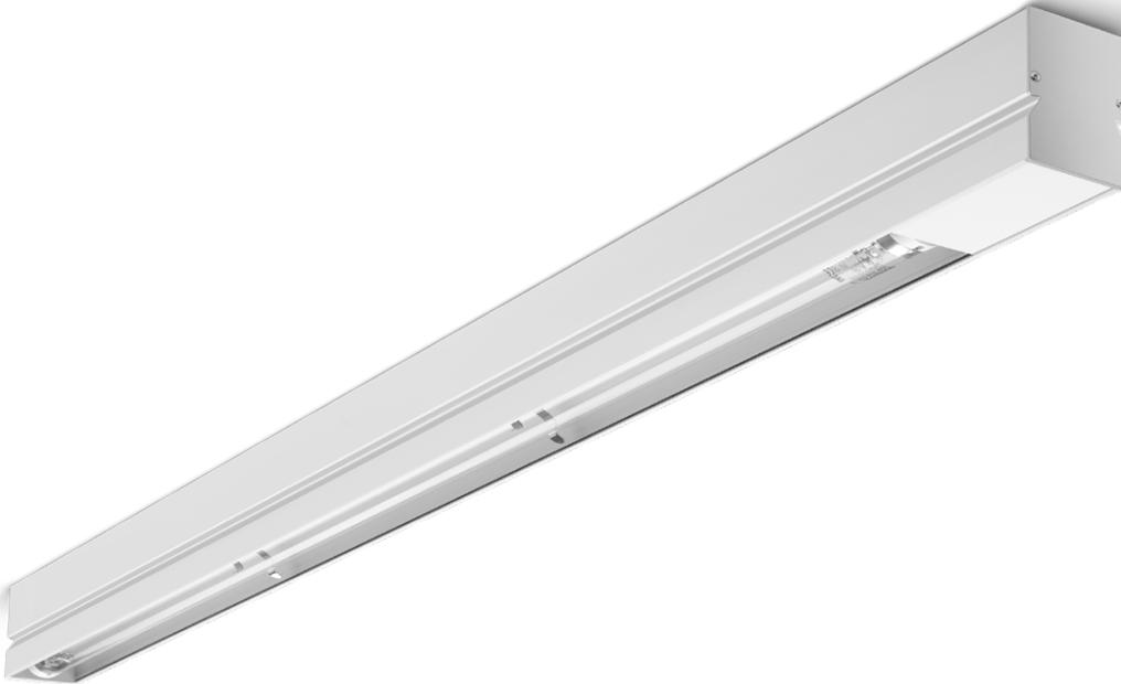
Antilia A-69-UV-Care ist eine professionelle Decken- und Wandleuchte zur Dekontamination von Luft und Oberflächen mittels ultravioletter Strahlung, zur einfachen Deckenmontage, aufgehängt oder als Wandleuchte. Beleuchtungswinkel lässt sich einstellen mittels Drehschalter an den Seiten des Gehäuses. Erhältlich in zwei Längen (75 cm und 135 cm) und drei Leistungen (18 W, 40 W und 80 W).
